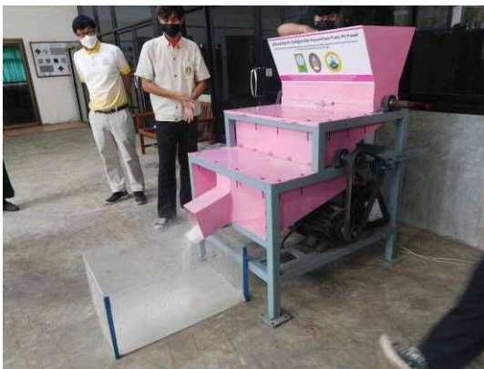
大学開発のポリウレタンフォーム破碎機
