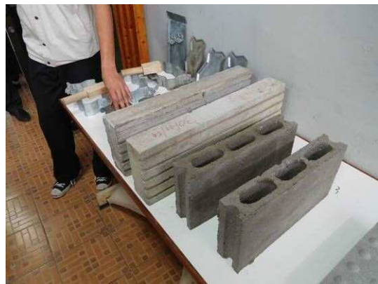
コンクリート 2 次製品 (破碎したポリウレタンフォームを含有)
