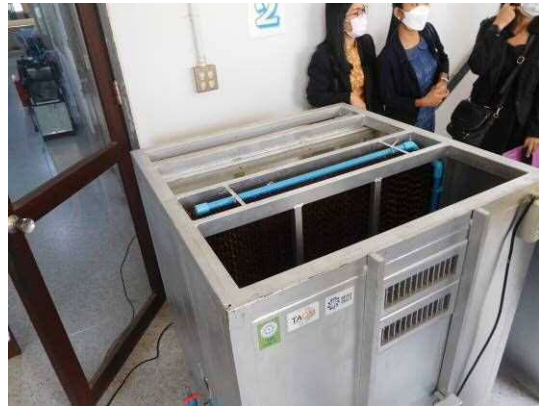
廃ポリウレタンフォームを活用した送風機 (フィルターに破碎 PU フォームを活用)
