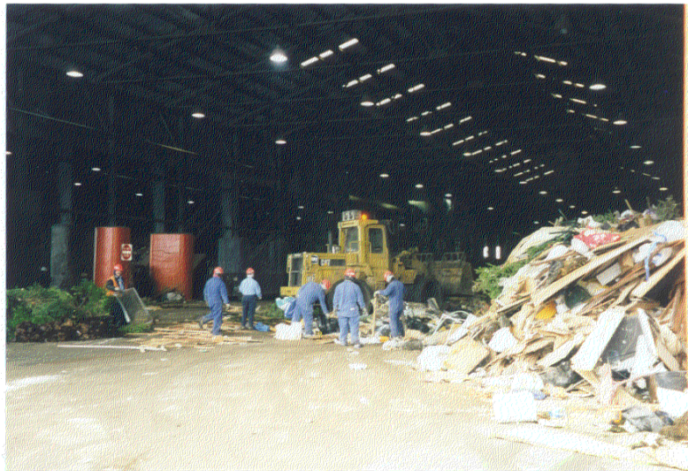
〈作業員が手作業で一般ごみ（家庭ごみおよび事業系ごみ）と資源ごみに分別している〉
