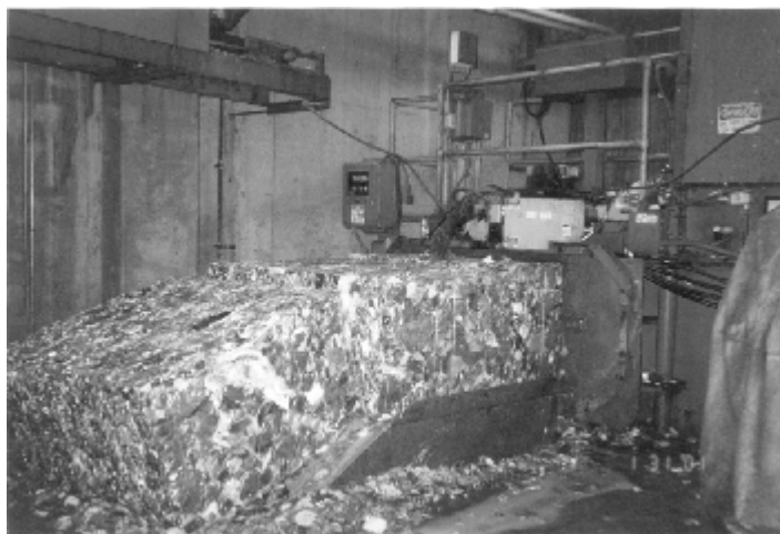
〈機械により金属容器を原料に加工している〉
