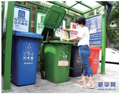
北京市海淀地区に設置された新型スマートゴミステーション。赤外線センサーにより、蓋が自動で開く仕組みなどを搭載している（2020年6月12日の新華網 NEWS より）
