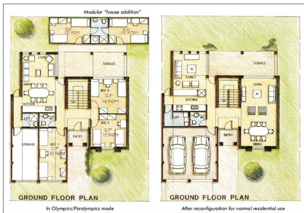
図1-38 オリンピック終了後の住宅への改修プラン（左がオリンピック時、右がオリンピック終了後。なお、左写真上部が移動式の簡易住宅） 97
