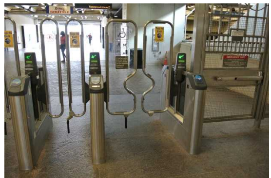
「MARTA」鉄道路線には、車椅子、ベビーカー、自転車等に対応した改札が整備されており、自転車の持ち込みが容易である。（写真:市内中心部 Five Points 駅の改札。）
