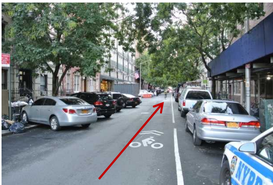
ニューヨーク市内「Class 3」参考例。道路上に自転車が通行するルートを示す標示(Sharrow)が設けられているが、自動車と走行帯を共用しているため、安全性は高くない。
