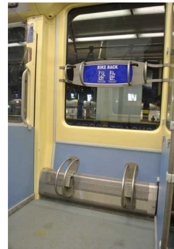
ミネソタ州ミネアポリス市のライトレール・トランジット(LRT)内に設けられた自転車ラックの例。
