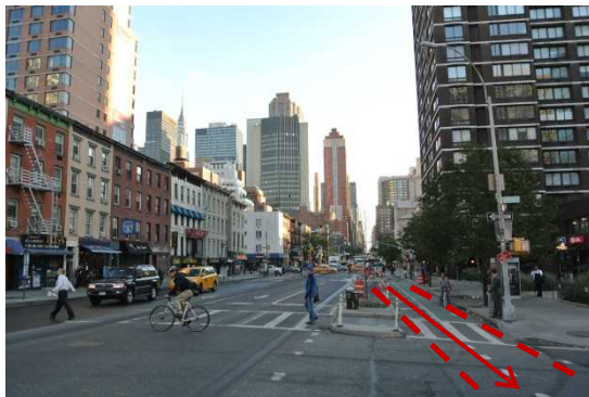
ニューヨーク市内「Class 1」参考例。写真右側の歩道に隣接し設置されている。車道とは緩衝帯により分離されている。
